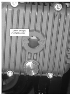
Εικόνα. Παράθυρα ελέγχου στάθμης λαδιού αντλίας.
